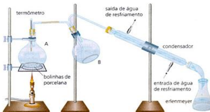
FIGURA 1 - MODELO DE DESTILAÇÃO A VAPOR
