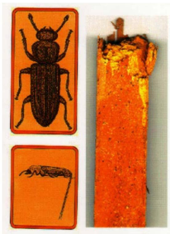
Figura 7. Aspecto do coleóptero *Lyctus brunus* adulto, no alto; representação do inseto ovopositando a certa profundidade na madeira, abaixo e à esquerda, e aspecto de uma peça de madeira severamente atacada.
