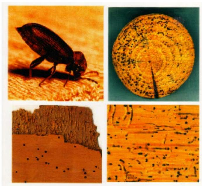
Fig.11: *Anobium punctatum* e material atacado (seção transversal de madeira roliça, capa e contracapa de chapa compensada; e interior de madeira maciça, após remoção da camada superficial).
