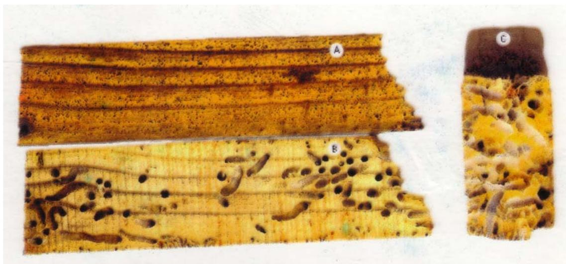
Figura 22. Madeira atacada por *Teredo navalis*: A) superfície da peça de pinus sp. atacada; B) interior da peça em corte longitudinal; C) vista do interior da peça na face transversal.
