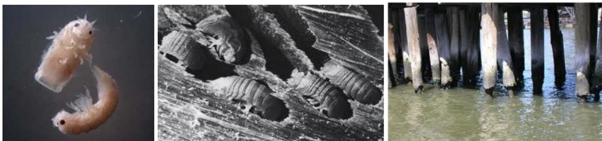
Figura 21: Exemplares de *Limnoria* spp., forma de ataque à madeira e dano tipo ampulheta observado e madeira roliça instalada em contato com a água do mar.
