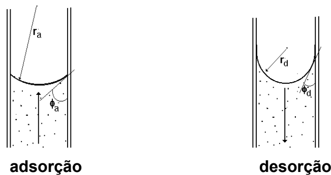
Figura 21. Diferentes formações de meniscos nos capilares da madeira durante a adsorção e a desorção - diferentes ângulos de humectação \phi -
