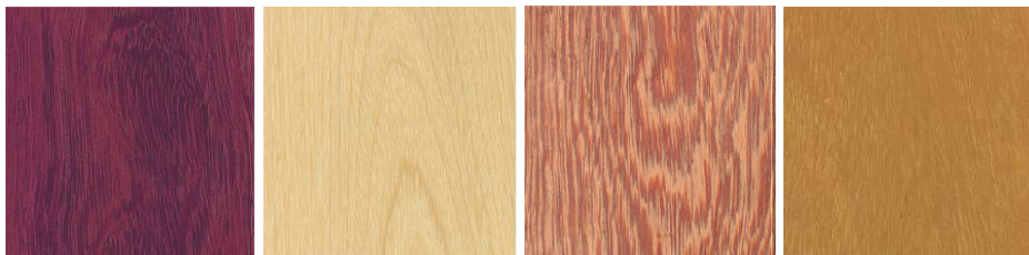
Figura 45: Exemplo de diferentes cores na madeira: roxinho, piquiarana, angelim pedra e tatajuba. (Fonte: Nahuz et al. 2012)
