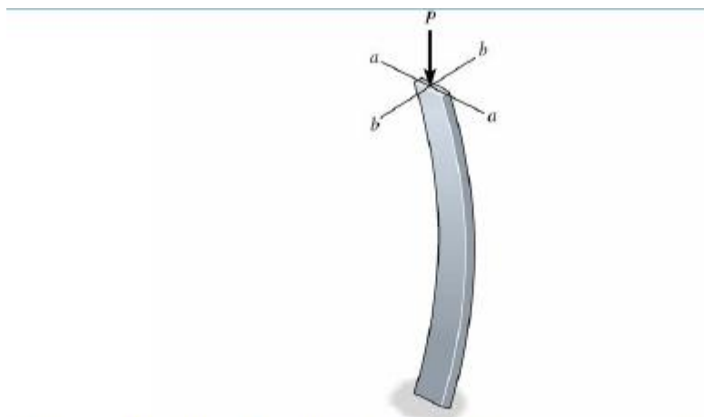
Figura 37 – Flambagem da coluna em torno do eixo com menor momento de inércia.
