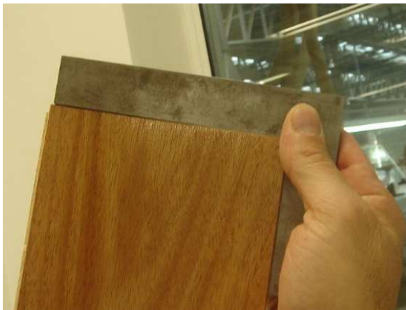
Fig.15 Esquadro para conferência dos 4 cantos do piso
