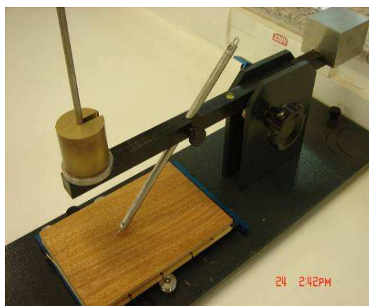
Fig 20. Ponteira agulha para ensaio risco
