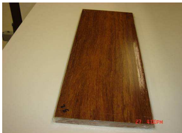
Fig.28 Isolamento das laterais do piso
